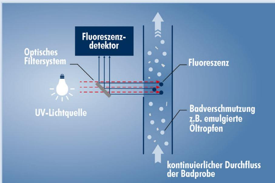
Typische Verschmutzungen industrieller Reinigungsbäder wie Öle und Fette fluoreszieren bei Anregung mit ultraviolettem Licht. Die gemessene Intensität der Fluoreszenz-Strahlung steigt mit der Konzentration der Öle und Fette. Die Anregung der Fluoreszenz erfolgt durch eine integrierte UV-Lichtquelle. Ein Detektor misst die Intensität der erzeugten Fluoreszenzstrahlung.
